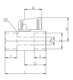
DN entspricht dem Nenn-Durchflussdurchmesser.
