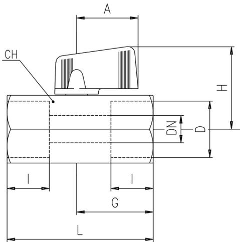
DN entspricht dem Nenn-Durchflussdurchmesser.
